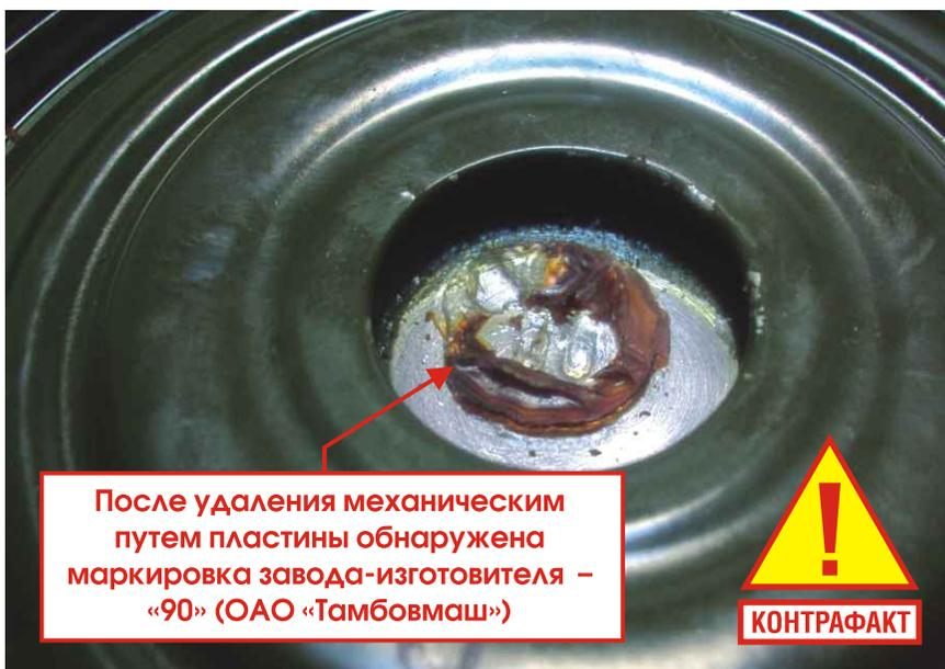
После удаления механическим путем пластины обнаружена маркировка завода-изготовителя – «90» (ОАО «Тамбовмаш»)
