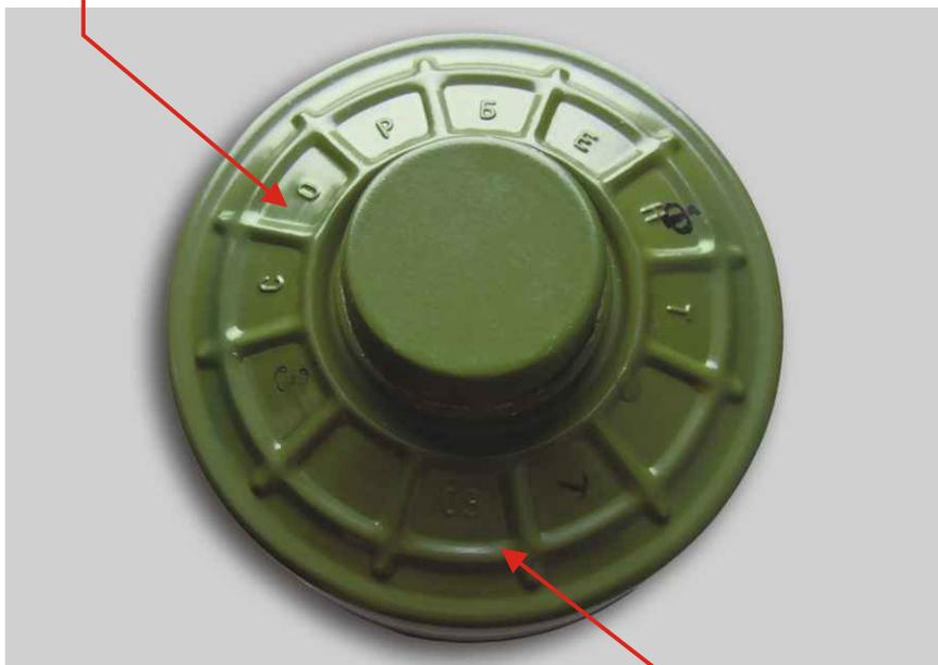
Год изготовления, который также выполнен методом выштамповки изнутри (две последние цифры года).
