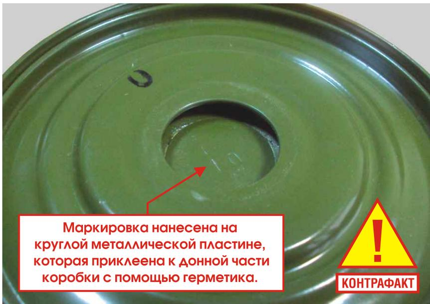
Маркировка нанесена на круглой металлической пластине, которая приклеена к донной части коробки с помощью герметика.
