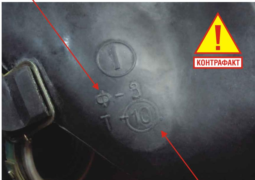
**При тщательном рассмотрении маркировки на корпусе маски видно, что оттиск (цифра «10» и две точки) очень рельефный и «свежий» по сравнению с остальными «размытыми» и «потертыми» оттисками и выполнен путем дополнительной вулканизации резины (след в виде круга) поверх удаленной исходной маркировки.**
